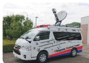
車載型衛星通信アンテナ
